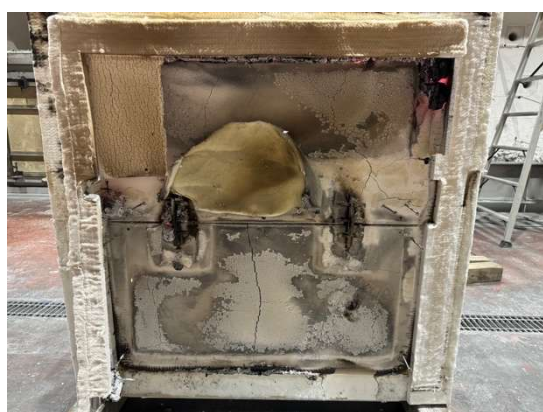
写真 3.1.3-2-1 加熱面・脱炉後 (試験体 2-2)
