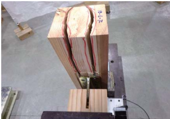
鉛直材の割れ (1. 2ch側)
