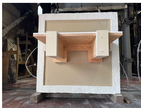
写真 3.1.3-3-2 加熱面正面・実験開始前 (試験体 3-1)
