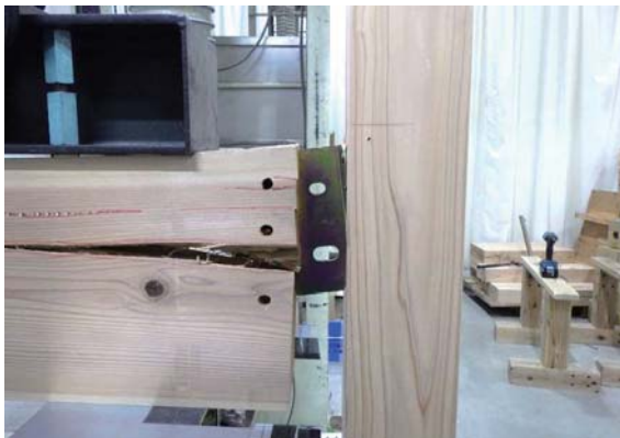
横架材の割れ(1. 2ch側)
