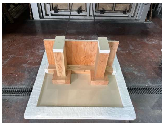
写真 3.1.3-2-1 加熱面下面・実験開始前 (試験体 2-1)
