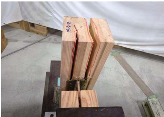
鉛直材の割れ(3. 4ch側)
