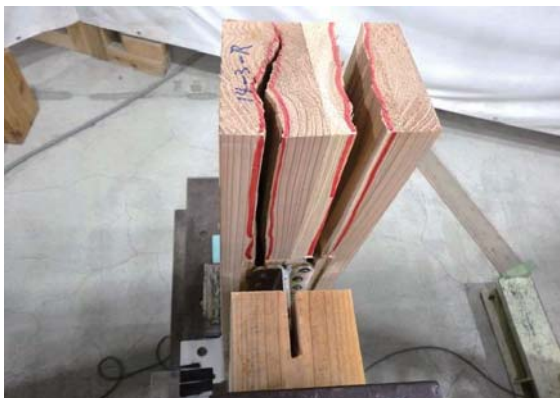
鉛直材の割れ (3. 4ch側)
