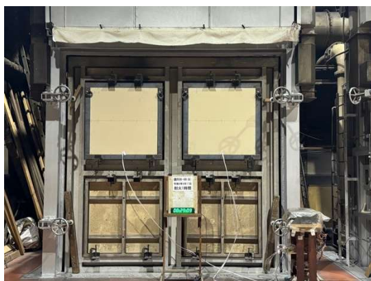
写真 3.1.3-1-7 7 時間半放冷終了後 (左：試験体 1-1、右：試験体 1-2)
