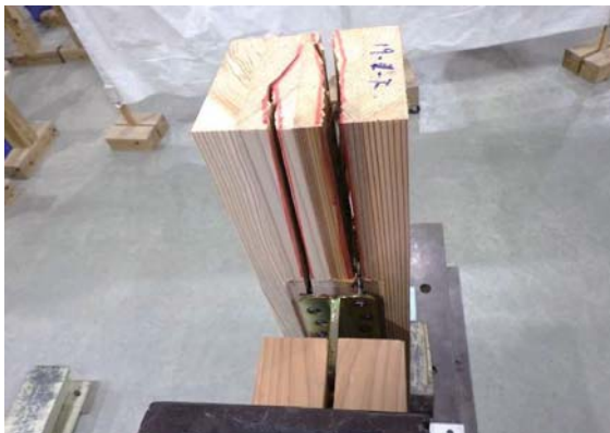
鉛直材の割れ(1. 2ch側)
