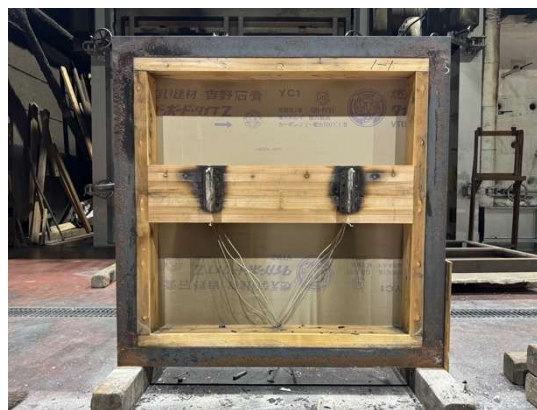
写真 3.1.3-1-10 解体時・梁金物付 (試験体 1-1)
