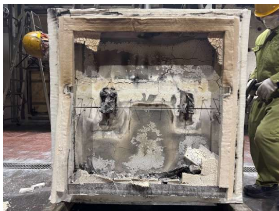
写真 3.1.3-3-9 加熱面・脱炉後 (試験体 3-2)
