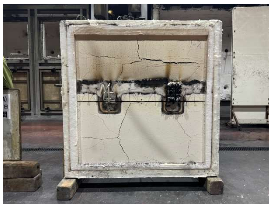
写真 3.1.3-1-9 加熱面・脱炉後 (試験体 1-2)
