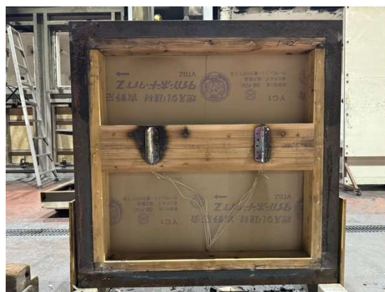
写真 3.1.3-1-14 解体時・梁金物付 (試験体 1-2)
