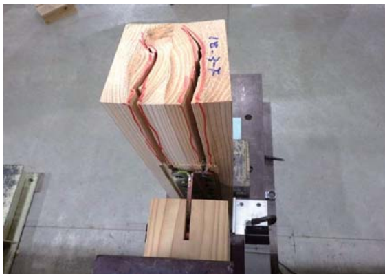
鉛直材の割れ (1. 2ch側)
