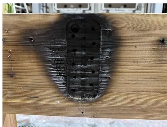
写真 3.1.3-2-1 解体時・梁カラマツ被覆 (試験体 2-1・仕様 1)
