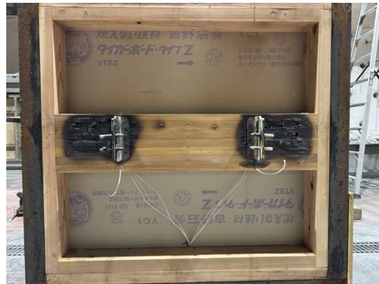
写真 3.1.3-2-1 解体時・梁金物付 (試験体 2-2)
