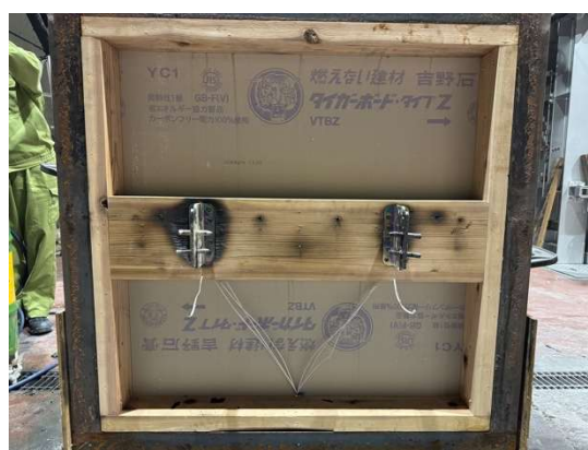
写真 3.1.3-2-1 解体時・梁金物付 (試験体 2-1)
