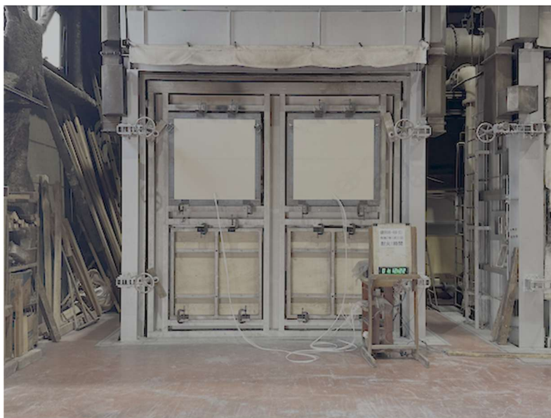
写真 3.1.2-1 日本住宅・木材技術センターの壁耐火炉に試験体を設置した様子
