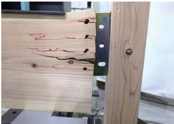
横架材の割れ (3. 4ch側)
