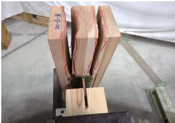
鉛直材の割れ (3. 4ch側)
