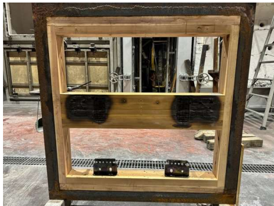
写真 3.1.3-2-1 解体時・梁表面 (試験体 2-2)
