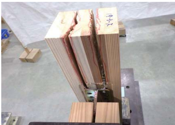
鉛直材の割れ(1. 2ch側)
