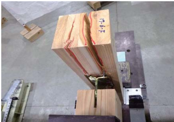
鉛直材の割れ(1. 2ch側)
