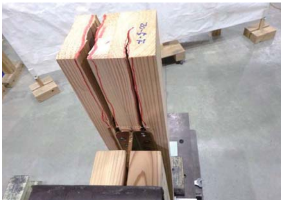
鉛直材の割れ (1. 2ch側)
