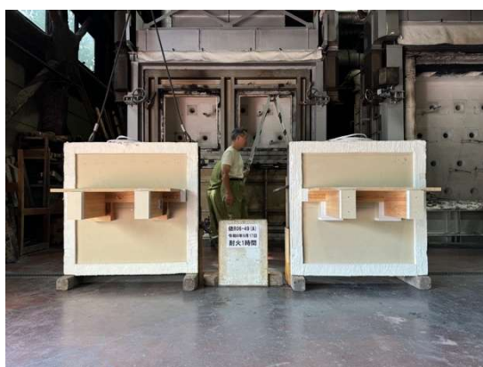
写真 3.1.3-1-1 加熱面・実験開始前 (左：試験体 1-1、右：試験体 1-2)
