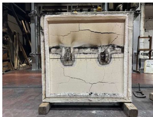
写真 3.1.3-1-8 加熱面・脱炉後 (試験体 1-1)
