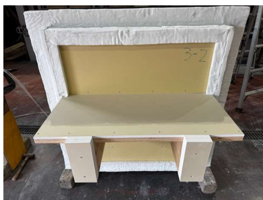
写真 3.1.3-3-5 加熱面上面・実験開始前 (試験体 3-3)
