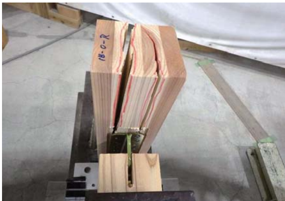
鉛直材の割れ (3. 4ch側)
