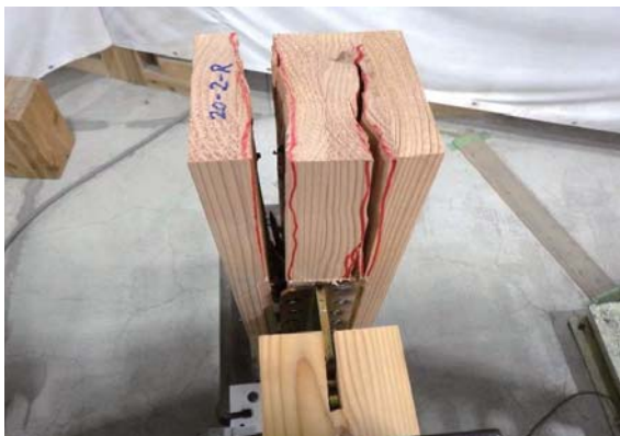
鉛直材の割れ (3. 4ch側)
