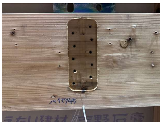
写真 3.1.3-3-13 解体時・梁ベイマツ被覆 (試験体 3-1・仕様 2)
