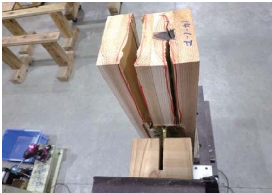
横架材の割れ (1. 2ch側)
