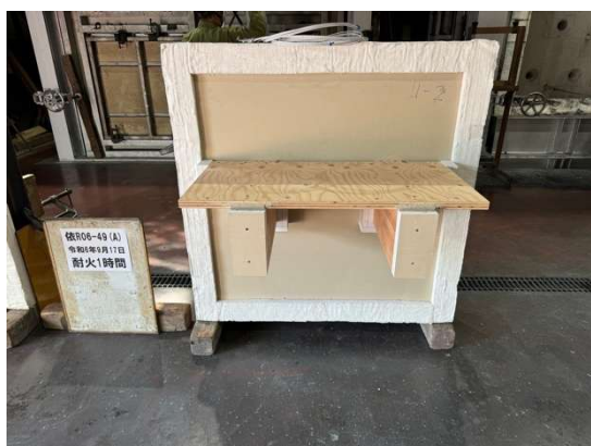
写真 3.1.3-1-5 加熱面上面・実験開始前 (試験体 1-2)
