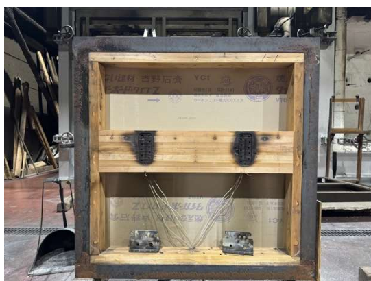
写真 3.1.3-1-11 解体時・梁表面 (試験体 1-1)
