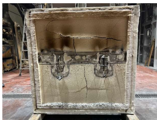
写真 3.1.3-2-1 加熱面・脱炉後 (試験体 2-1)
