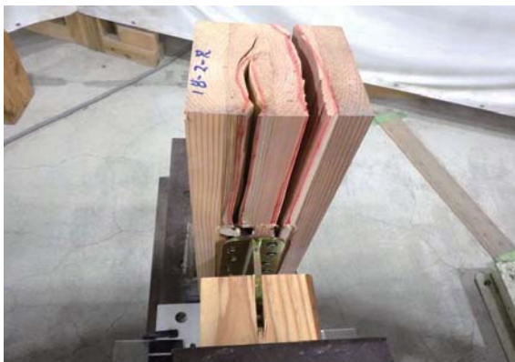
鉛直材の割れ (3. 4ch側)
