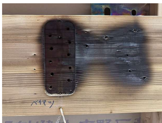
写真 3.1.3-3-17 解体時・ベイマツ被覆 (試験体 3-2・仕様 4)
