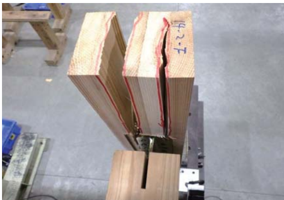
鉛直材の割れ (1. 2ch側)
