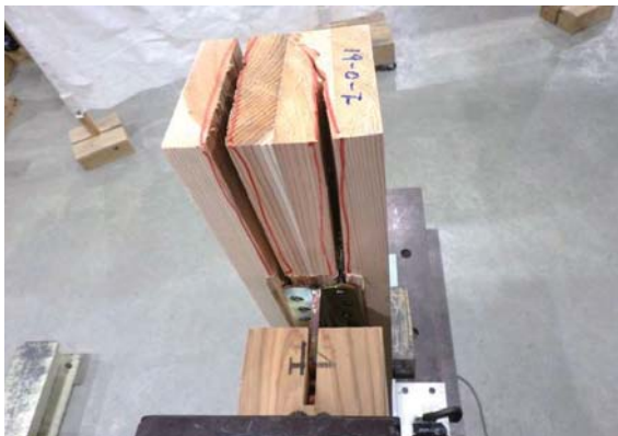
鉛直材の割れ(1. 2ch側)
