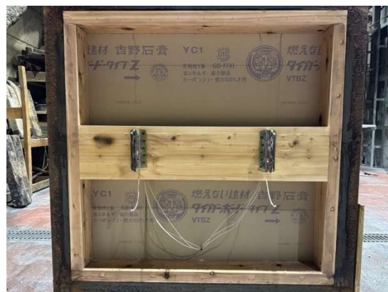
写真 3.1.3-3-10 解体時・梁金物付 (試験体 3-1)
