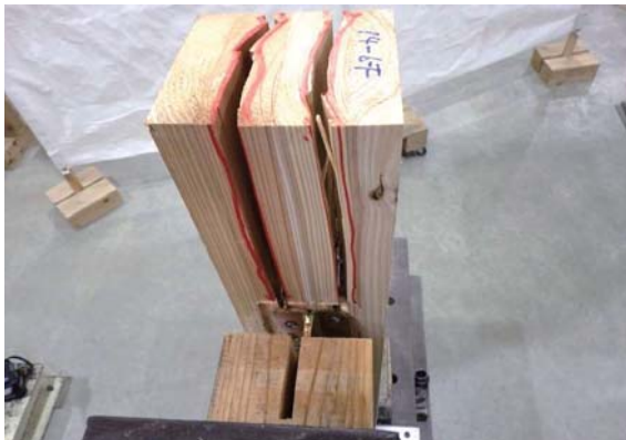
横架材の割れ (1. 2ch側)
