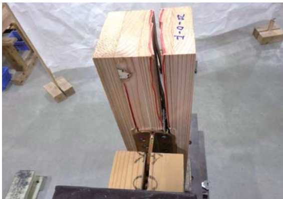
鉛直材の割れ (1. 2ch側)
