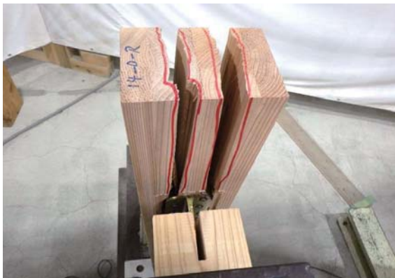
鉛直材の割れ (3. 4ch側)
