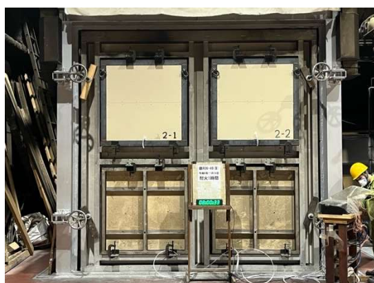
写真 3.1.3-2-1 7 時間半放冷終了後 (左：試験体 2-1、右：試験体 2-2)
