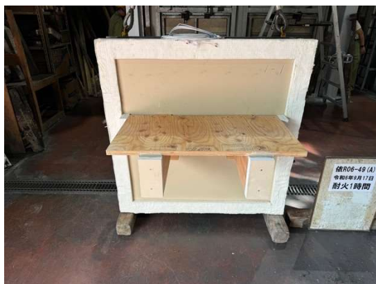
写真 3.1.3-1-3 加熱面上面・実験開始前 (試験体 1-1)
