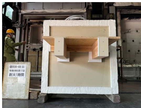
写真 3.1.3-1-4 加熱面正面・実験開始前 (試験体 1-2)
