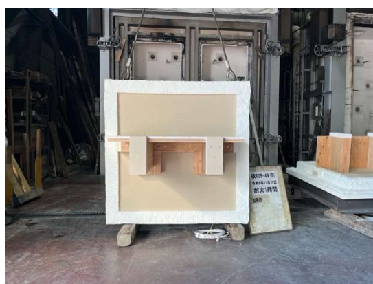
写真 3.1.3-2-1 加熱面正面・実験開始前 (試験体 2-1)
