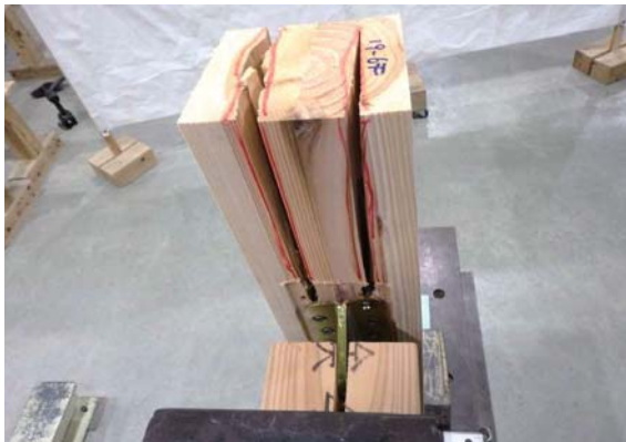
鉛直材の割れ(1. 2ch側)
