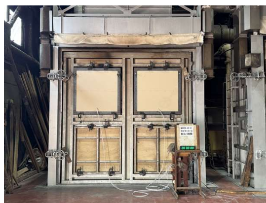
写真 3.1.3-3-6 加熱開始時 (左：試験体 3-1、右：試験体 3-2)
