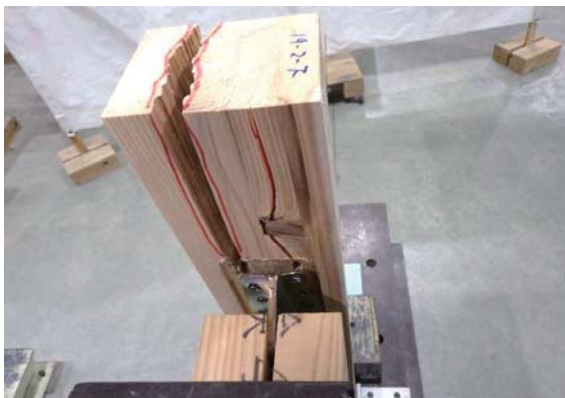
鉛直材の割れ(1. 2ch側)
