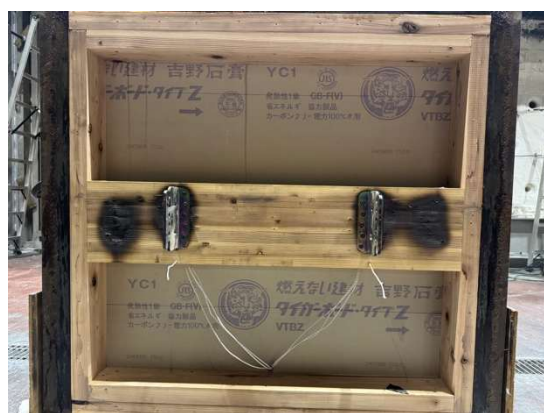
写真 3.1.3-3-14 解体時・梁金物付 (試験体 3-2)
