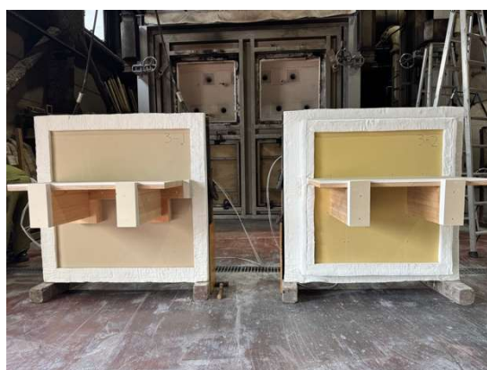
写真 3.1.3-3-1 加熱面・実験開始前 (左：試験体 3-1、右：試験体 3-2)
