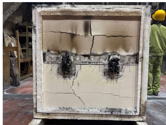
写真 3.1.3-3-8 加熱面・脱炉後 (試験体 3-1)
