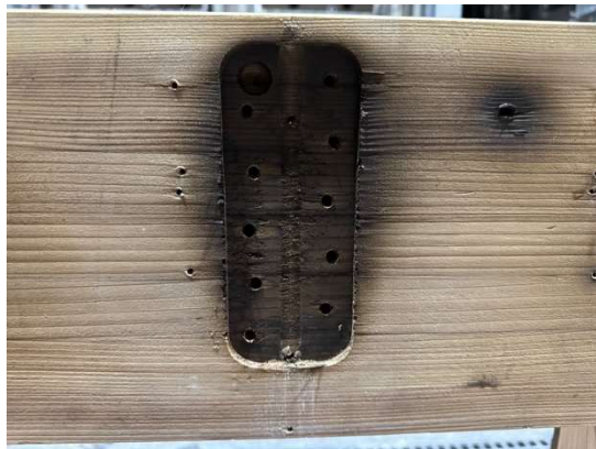
写真 3.1.3-2-1 解体時・梁ベイマツ被覆 (試験体 2-1・仕様 2)
