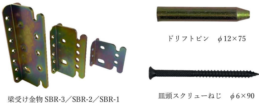
写真 2.1-1 梁受け金物 SBR シリーズ及び接合具
