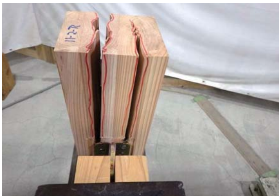
鉛直材の割れ (3. 4ch側)
