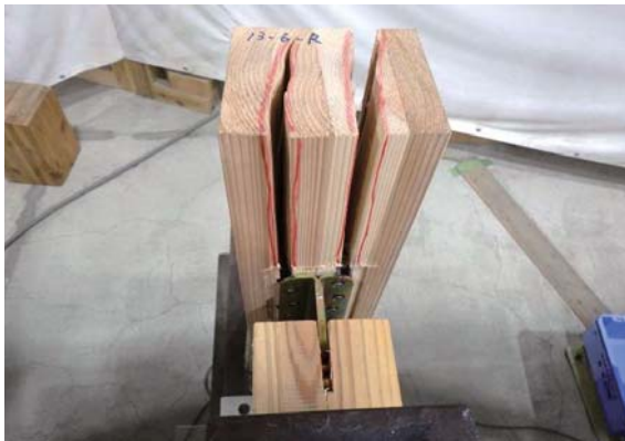
鉛直材の割れ (3. 4ch側)
