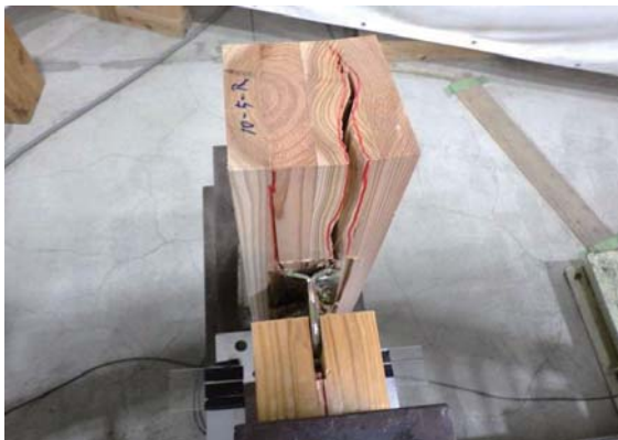
鉛直材の割れ (3. 4ch側)
