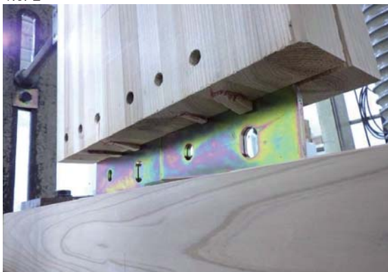
鉛直材の割れ
