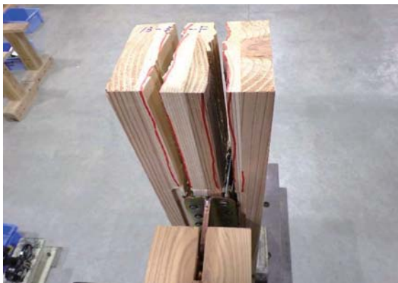
鉛直材の割れ (1. 2ch側)
