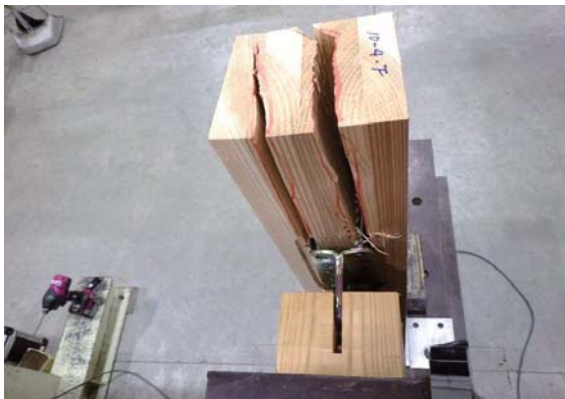
鉛直材の割れ (1. 2ch側)
