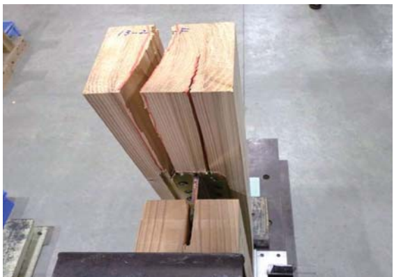
鉛直材の割れ (1. 2ch側)
