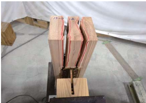
鉛直材の割れ (3. 4ch側)
