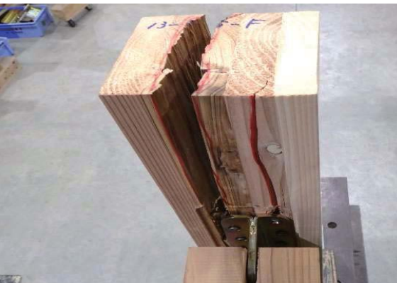
鉛直材の割れ (1. 2ch側)
