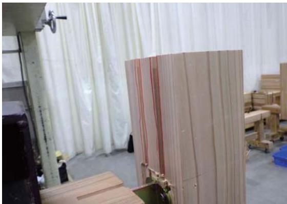
鉛直材の割れ (1. 2ch側)
