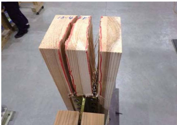
鉛直材の割れ (1. 2ch側)
