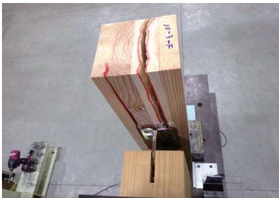
鉛直材の割れ (1. 2ch側)
