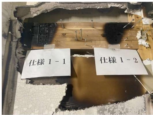
写真 3.1.3-17 加熱面・脱炉直後の解体時
