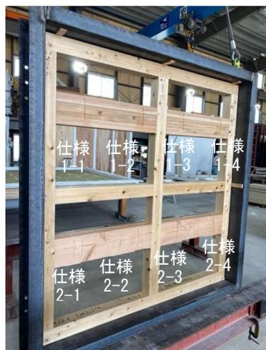
写真 3.1.2-1 火構造壁内の梁の施工状況
