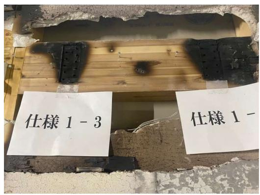
写真 3.1.3-18 加熱面・脱炉直後の解体時
