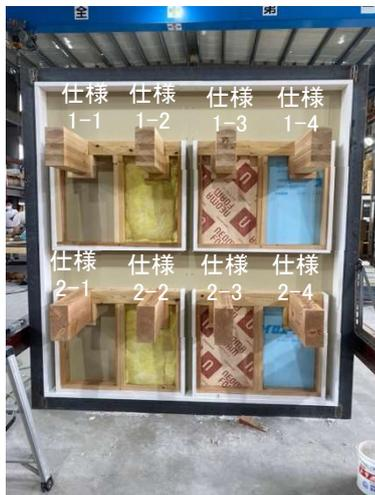
写真 3.1.2-9 断熱材の施工状況
