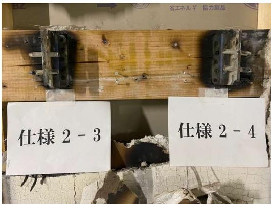
写真 3.1.3-15 加熱面・脱炉直後の解体時
