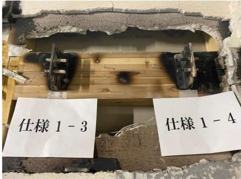
写真 3.1.3-13 加熱面・脱炉直後の解体時
