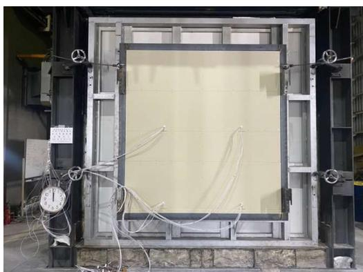
写真 3.1.3-6 非加熱面・実験開始時
