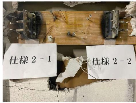
写真 3.1.3-14 加熱面・脱炉直後の解体時
