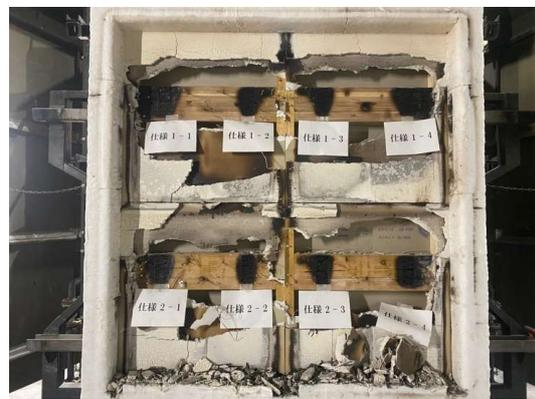
写真 3.1.3-16 加熱面・脱炉直後の解体時
