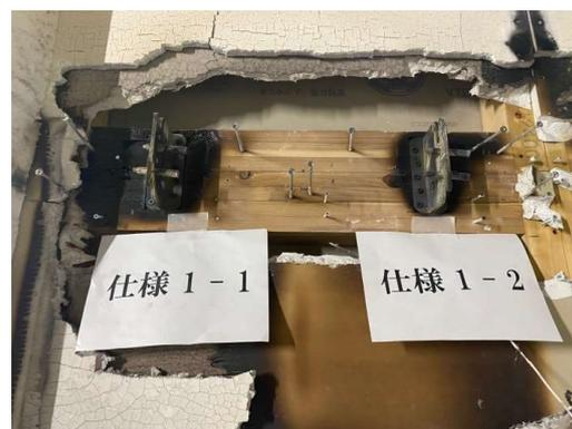
写真 3.1.3-12 加熱面・脱炉直後の解体時
