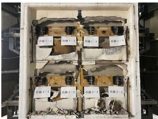
写真 3.1.3-11 加熱面・脱炉直後の解体時
