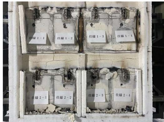
写真 3.1.3-10 加熱面・脱炉時
