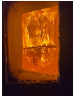
写真 3.1.3-8 1 時間加熱直後の炉内の様子
