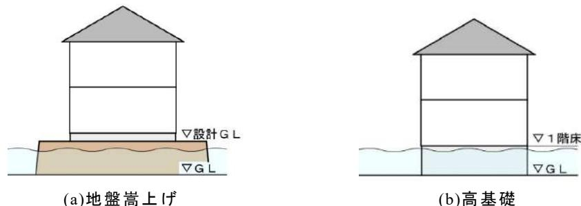
図 4.5.2 住宅 Dry タイプ-設計用浸水深が深い場合の浸水対策イメージ
