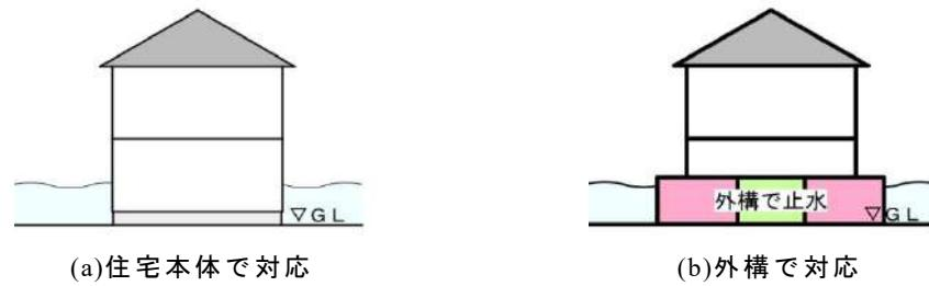
図 4.5.1 住宅 Dry タイプ-設計用浸水深が浅い場合の浸水対策イメージ
