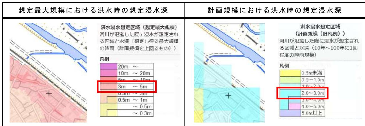
図 4.4.3 想定最大規模及び計画規模における洪水時の想定浸水深
