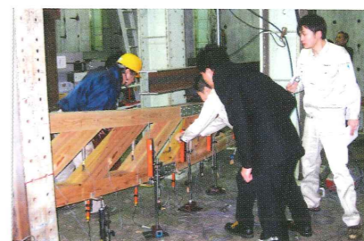
実大モデルの強度試験
