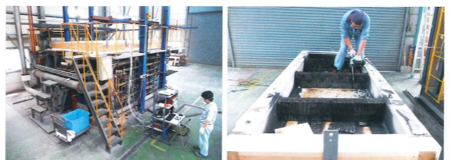
耐火試験実施中と実施後の床・試験体
